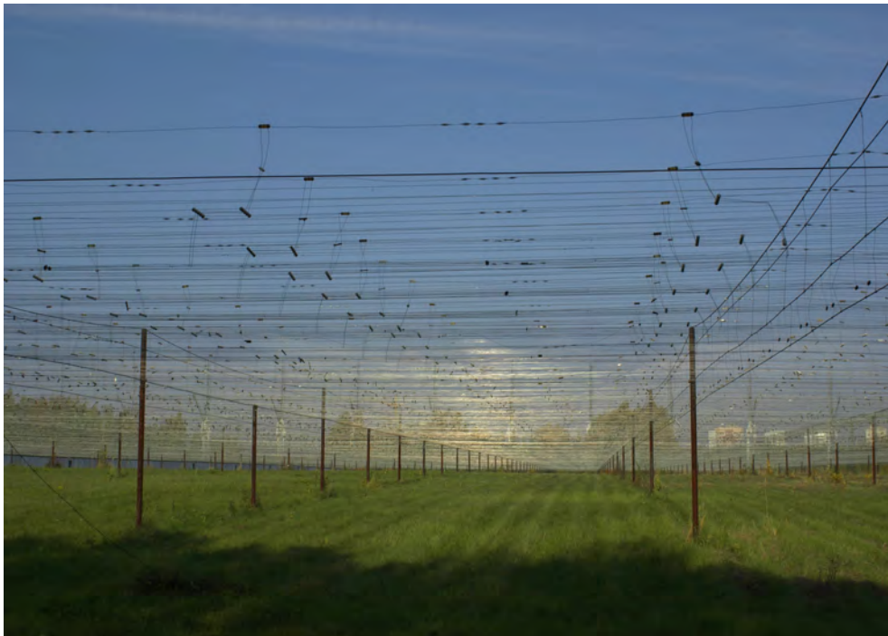
Figura 3.8: Arreglo del BSA en el observatorio PRAO en Rusia. El BSA es un arreglo de 16384 dipolos ( \lambda = 3 m) que cubre 7,200 m 2 . Es un instrumento de tránsito compuesto de un arreglo plano de dipolos. Cortesía de I. V. Chashei.
