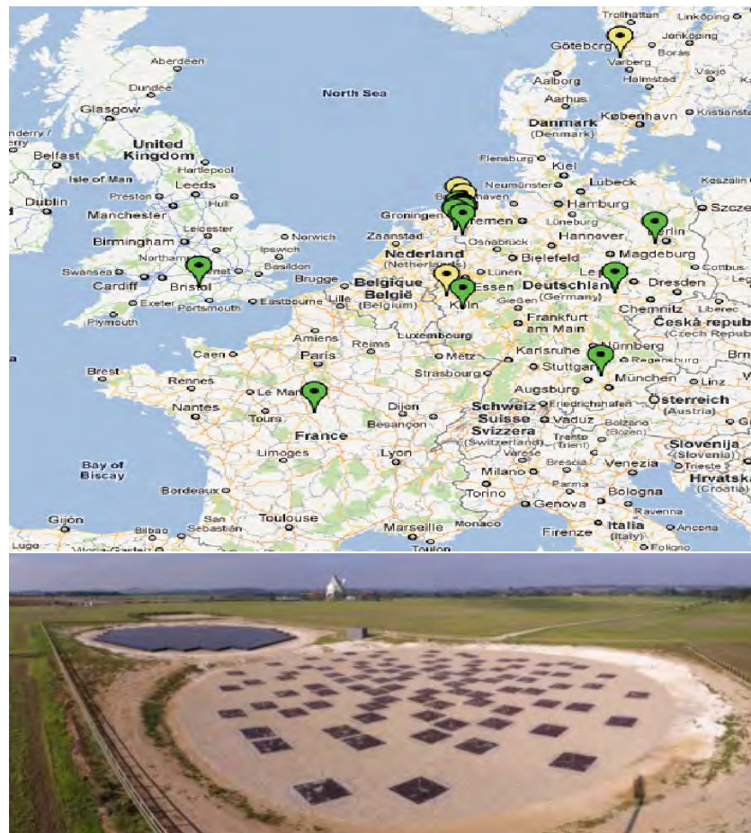
Figura 3.13: Arriba: Distribución de estaciones en Europa de LOFAR. La mayoría se encuentran al noreste de Holanda; tomada de http://www.astron.nl/~heald/lofarStatusMap.html . Abajo: Una estación de LOFAR en Chilbolton, Reino Unido. En el área del frente está el arreglo de dipolos de baja frecuencia limitado por una circunferencia ( \sim 100 m de diámetro). Los dipolos están en forma de 'v' invertida sobre los pequeños cuadros planos. Al fondo, se encuentra el arreglo de dipolos de alta frecuencia también limitado por una circunferencia ( \sim 100 m de diámetro), los dipolos están dentro unas celdas; Cortesía de M. Bisi.
