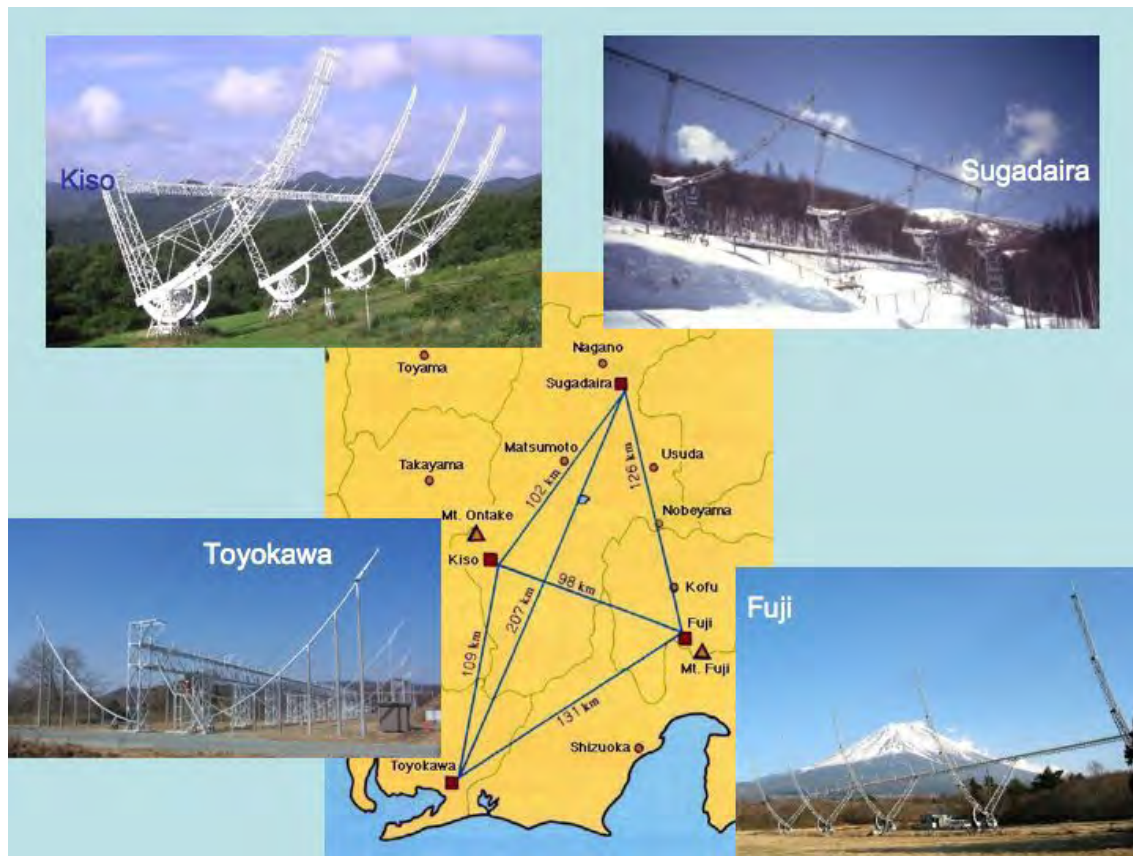
Figura 3.10: Ubicación de las cuatro antenas de STEL y fotografías de cada uno de los cuatro instrumentos. Las distancias entre los distintos radiotelescopios que componen el STEL se ilustran en kilómetros. Cortesía de M. Tokumaru.
