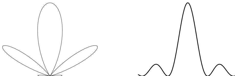
Figura 1.2: Izquierda: Representación de la sección transversal de un haz radiado por una antena. Derecha: Firma del flujo producido por el tránsito de una fuente discreta al pasar por el haz principal y los lóbulos laterales. El ancho a potencia media de la forma gaussiana central es proporcional al ancho del haz que la observó.
