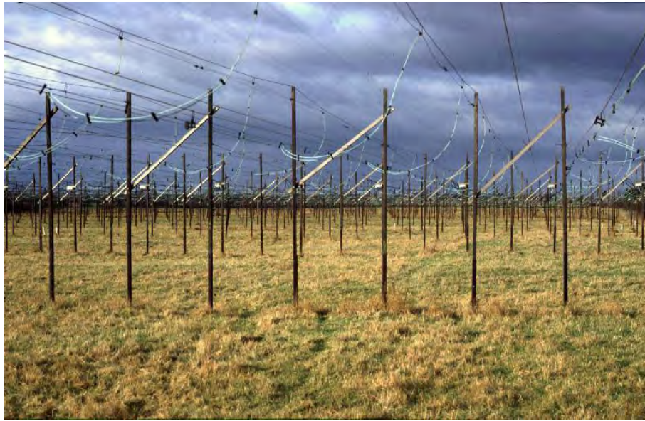
Figura 3.7: El Interplanetary Scintillation Array de Cambridge. El arreglo de Cambridge de 4096 dipolos cubría 3.6 hectáreas. Imagen tomada de http://radio.astro.gla.ac.uk/stellarlect/index.html .
