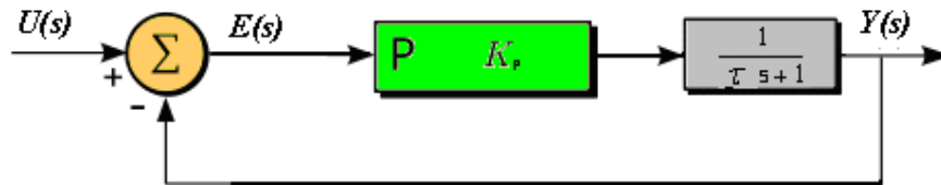
Figura 2.13. Diagrama de bloques del sistema con control proporcional.
