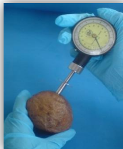
Figura 18. Penetrómetro manual utilizado para la determinación de firmeza.
