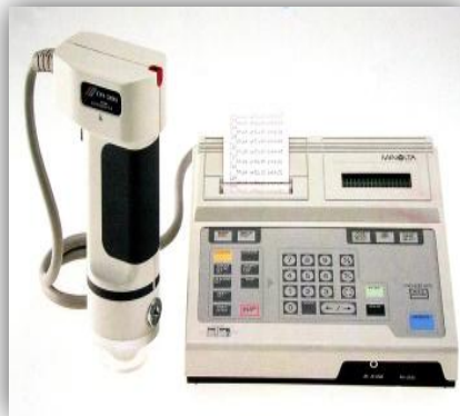
Figura 21. Colorímetro Minolta con sistema Hunter Lab.
