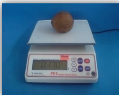
Figura 16. Balanza granataria utilizada para la determinación de la pérdida de peso.
