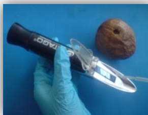
Figura 19. Refractómetro manual utilizado para la determinación de sólidos solubles.
