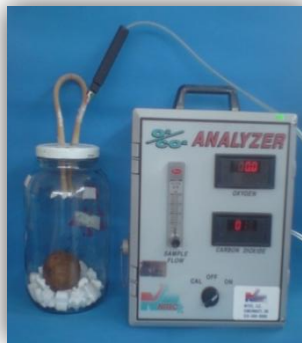
Figura 17. Analizador de gases utilizado para la determinación de la intensidad respiratoria.
