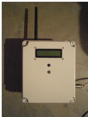
Figura 6.37.- Módulo de temperatura instalado
