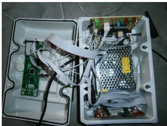
Figura 6.35.- Acoplamiento final del módulo de control y módulo GSM.
