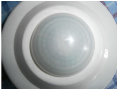
Figura 6.43.- instalación del sensor PIR
