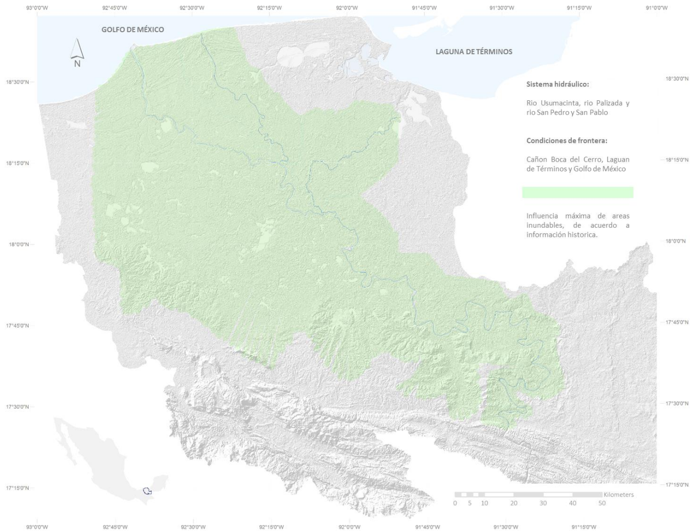
Figura 3.7 Trazado de la geometría del sistema Usumacinta, San Pedro-San Pablo, Palizada con sus respectivas llanuras de inundación. La configuración geométrica en hec-RAS consta de un cauce principal con secciones transversales perpendiculares al flujo, la extensión de cada sección transversal debe cubrir el área de inundación que se necesita analizar, por lo cual cada sección tendrá diferentes longitudes.
