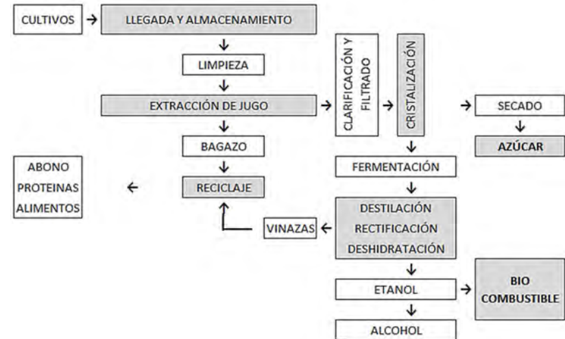
FIGURA 7.12: ESQUEMA COMPLETO DE TRANSFORMACIÓN DE CAÑA FUENTE: APUNTES Y NOTAS DEL AUTOR
