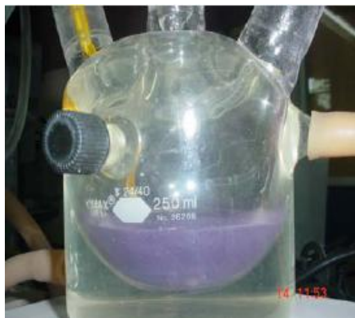
Fotografía 2.3.1. Reactor de tres bocas enchaquetado para las pruebas catalíticas.
