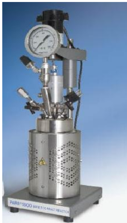
Fotografía 2.4.1. Reactor de acero inoxidable, en el que se realizó la experimentación.
