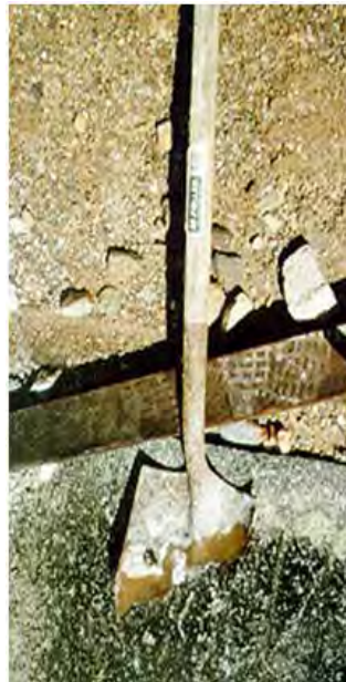
Figura 2. Drenaje ácido en las mina de Iron Mountain, en California. Algunos trabajadores dejaron accidentalmente la pala en un liquido que salía de la mina, al día siguiente la herramienta se había corroído (USEPA, 2006).
