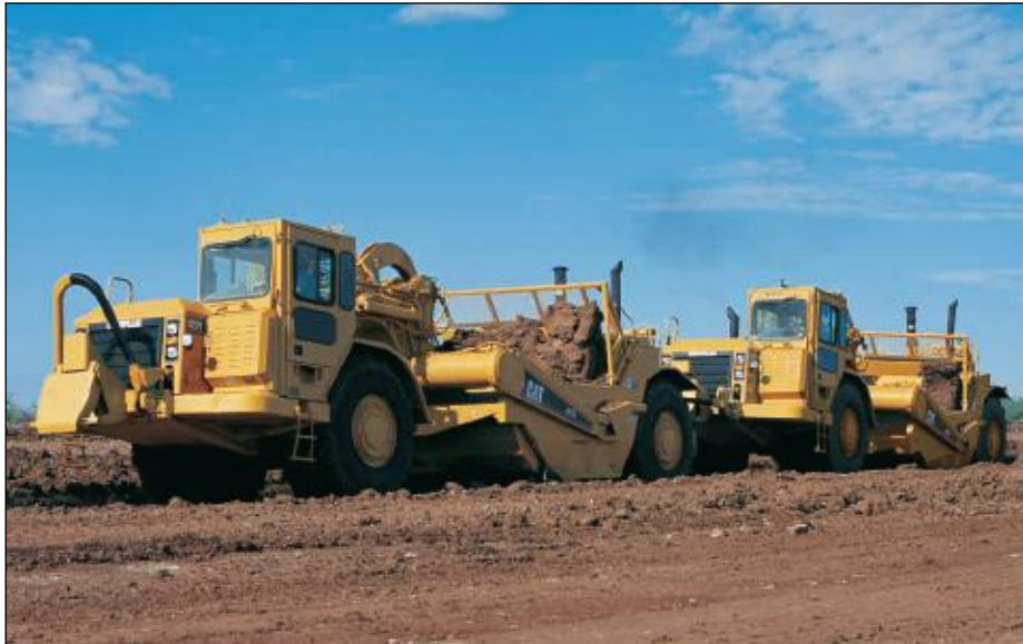
Funcionamiento de motoescrepas push-pull
