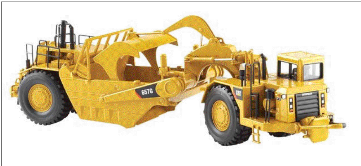
Motoescrepa de dos motores
