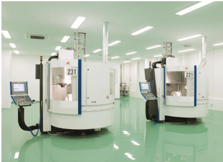
Figura 19 Unidades fresadoras de alta precisión Nobel Procera.
