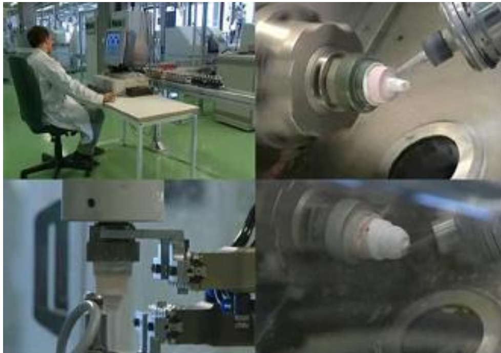
Figura 27 Fase de fresado, sistema Procera.
