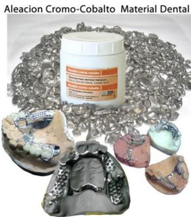
*Fig. 40 Aleación de cromo, utilizada para materiales dentales.*
