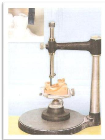
Figura 18 El paralelizador facilita el diseño de la prótesis dental parcial removible. Con este instrumento se determina en un modelo el paralelismo o la falta del mismo de los dientes pilares y otras estructuras.
