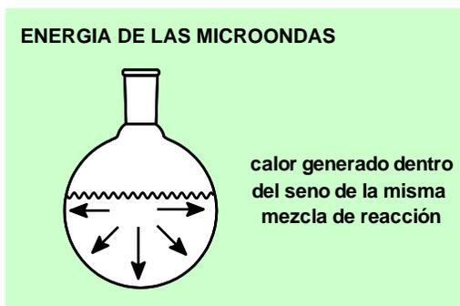
Esquema 4. Calentamiento microondas.
