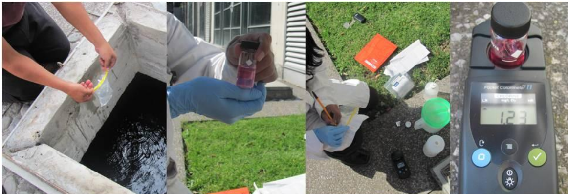
Figura 25. Toma de muestras y análisis in situ de calidad del agua, en cisternas de almacenamiento de Ciudad Universitaria, UNAM.
