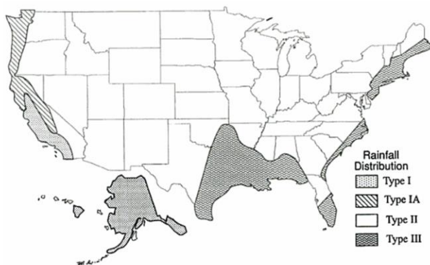
Figura 2-13. Zonas geográficas para aplicar las distribuciones de lluvia total en 24 h (SCS, 1986)
