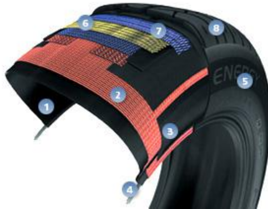
Figura 27.- Estructura de un neumático. 39
