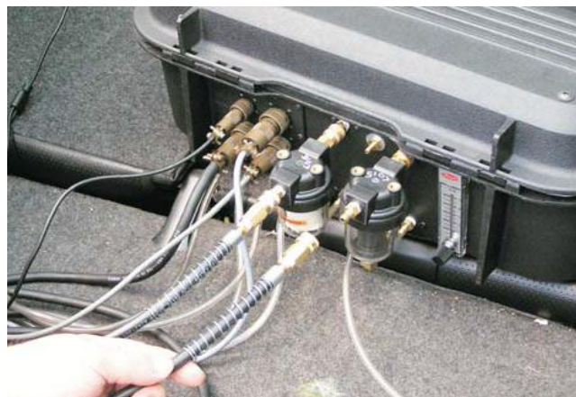
Figura 34.- Conexión de sensores al equipo de cómputo
