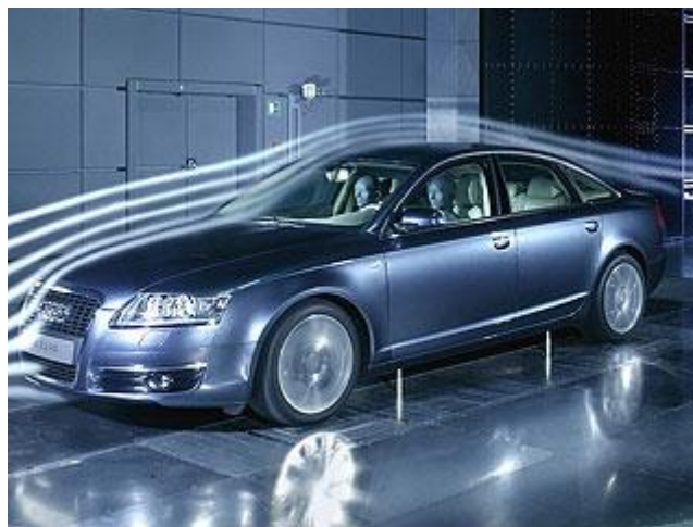
Figura 26.- Pruebas en túnel de viento de un Audi A5.
