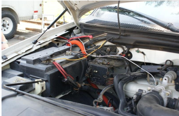
Figura 31.- Conexión del equipo a la batería de la Toyota Hilux
