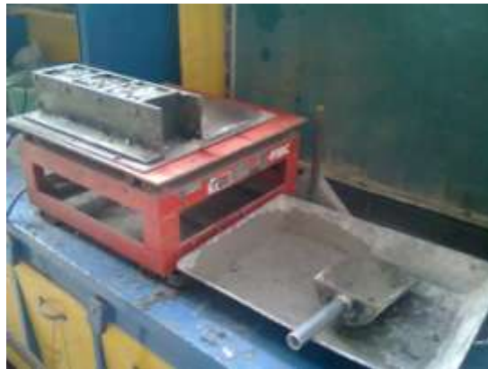
Figura 44. Colocación de la mezcla en el molde sobre la mesa vibratoria.
