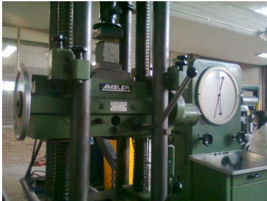
Figura 47. Prueba de resistencia a la compresión en una muestra
