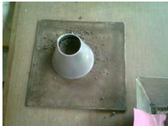
Figura 36. Colocación de arena dentro del cono
