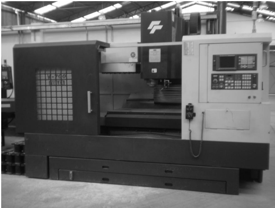
FIG. 7 Máquina Freeler, con capacidad de manejar 20 Herramientas en la torreta. Fotografía tomada en la Fabrica Mipsar de San Pedro Pozohuacan, Tecámac Edo. De Méx.
