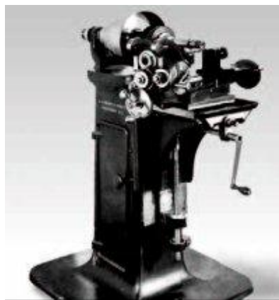
FIG. 5 Primera fresadora universal, fabricada por Joseph R. Brown en 1862. http://www.museo-maquina-herramienta.com/historia/Lehenengoko-erremintak/Fresatzeko-makinak .
