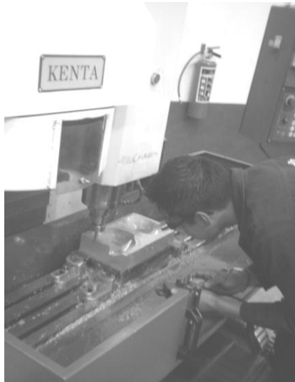
FIG. 78 Centrando el molde con bailarina o borrachito. Fotografía tomada en la Fabrica Mipsar de San Pedro Pozohuacan, Tecámac Edo. De Mex.
