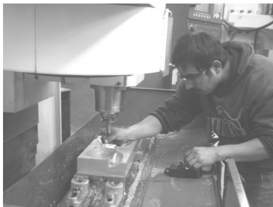
FIG. 79 Rozando la herramienta para obtener el offset con apoyo de un pedazo de papel. Fotografía tomada en la Fabrica Mipsar de San Pedro Pozohuacan, Tecámac Edo. De Mex.
