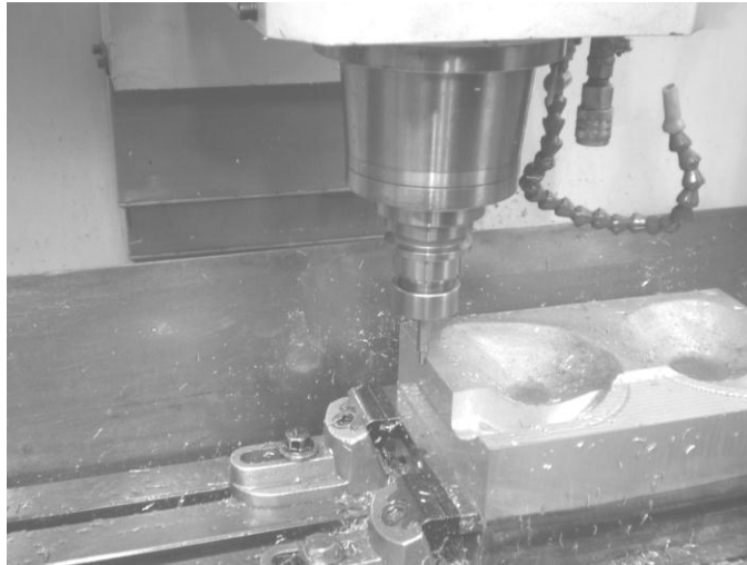
FIG. 78 Centrando el molde con bailarina o borrachito. Fotografía tomada en la Fabrica Mipsar de San Pedro Pozohuacan, Tecámac Edo. De Mex.
