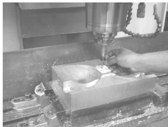
FIG. 79 Rozando la herramienta para obtener el offset con apoyo de un pedazo de papel. Fotografía tomada en la Fabrica Mipsar de San Pedro Pozohuacan, Tecámac Edo. De Mex.
