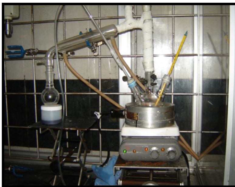
Figura 3.2. Equipo de destilación empleado para llevar a cabo la reacción.
