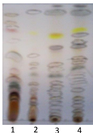
Figura 16. Perfil cromatográfico de los extractos orgánicos del hongo endófito SM2Fg3. 1) Extracto de \text{CH}_2\text{Cl}_2 del medio de cultivo, 2) Extracto de AcOEt del medio de cultivo, 3) Extracto de \text{CH}_2\text{Cl}_2 del micelio, y 4) Extracto de AcOEt del micelio. Cromatoplaca eluída con \text{CH}_2\text{Cl}_2 : AcOEt; 99:1 y revelada con \text{H}_2\text{SO}_4 al 10%.
