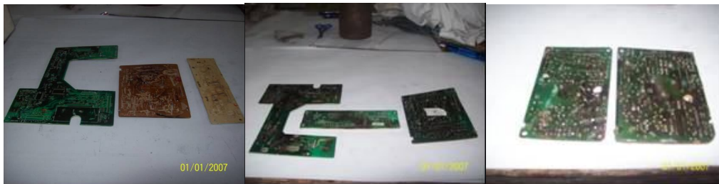
Figura 2.8 Tableros libres de soldadura y circuitos
