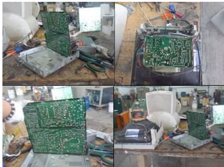
Figura 2.2 Tableros Electrónicos de monitores
