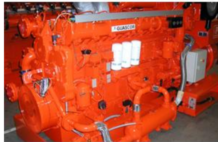
Figura 7. Motor de combustión interna alimentado con gas pobre (Dresser-Rand, 2012)
