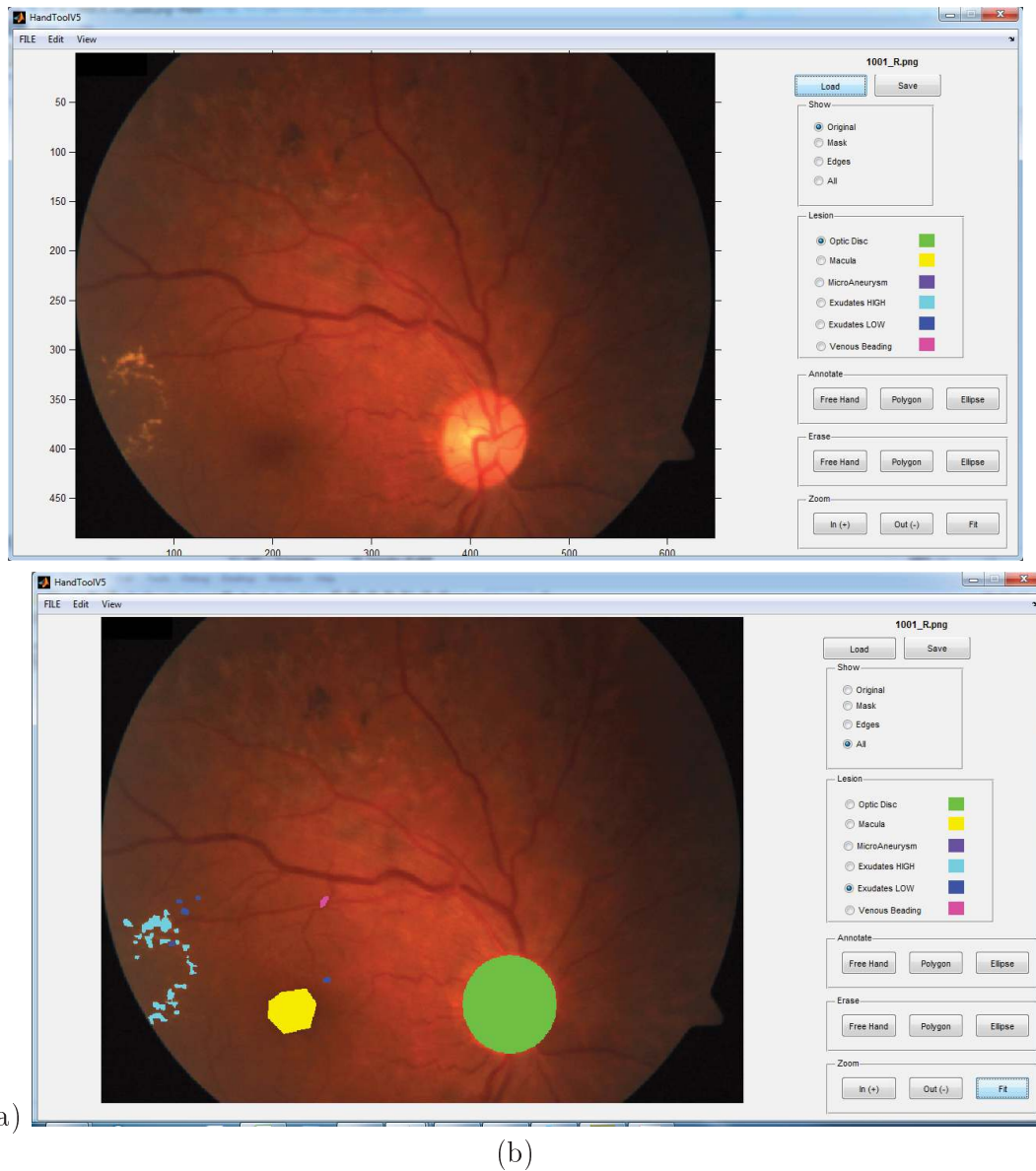
Figura 7.2: Herramienta de segmentación desarrollada para obtener las imágenes de estándar de oro (Ground Truth). (a) Vista inicial. (b) Ejemplo de la vista con segmentación de diferentes patrones. Se muestra en verde claro el etiquetado manual del disco óptico con la herramienta de elipse (Ellipse), en amarillo el etiquetado manual de la mácula con la herramienta de polígono (Polygon), en cyan el etiquetado manual de exudados de alta probabilidad con la herramienta de mano alzada (Free Hand), en azul oscuro el etiquetado manual de exudados con baja probabilidad con la herramienta de mano alzada, y finalmente en rosado el etiquetado manual de arrosamiento venoso con la herramienta de polígono.
