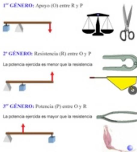
Fig. 3.3.75 Tipos de palanca
