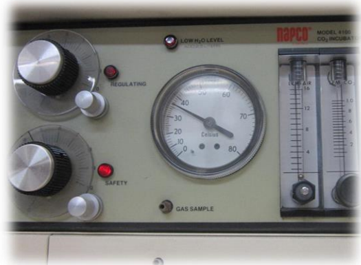
Figura 7. Incubadora de CO 2 NAPCO MODEL 4190 empleado para cultivo microaerofílico. (Tomada en INNSZ)
