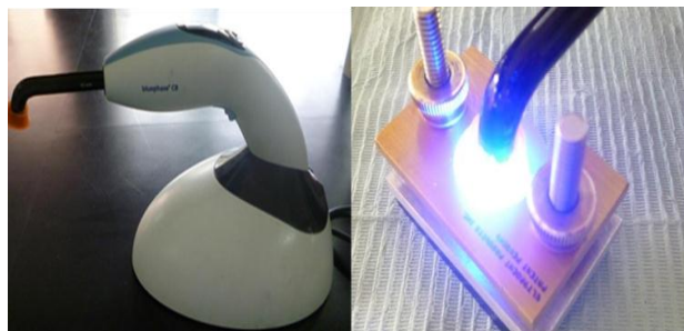
Fig. 15 Fotopolimerización de la resina con una lámpara de fotocurado, Bluephase C8, Ivoclar Vivadent.
