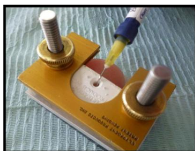
Fig.14 Aplicación de la resina en la muestra.
