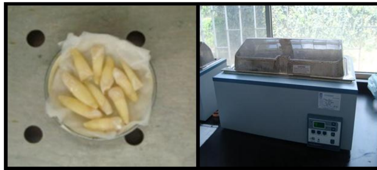
Fig. 7 Dientes con blanqueamiento dentro del aparato de baño maría a 37°C.
