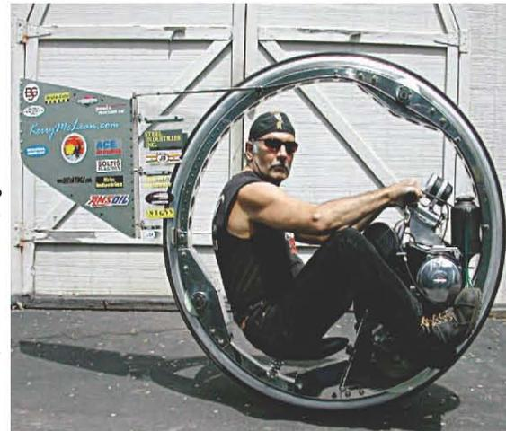
de un tractor remolque de un viñedo francés. Se controla con un embrague de lado izquierdo, el acelerador en el puño y un freno hidráulico de lado derecho. Está alineado un poco inclinado hacia fuera de la rueda, para que sea apto para circular. Está equipado con faros halógenos, luces de freno y su respectiva matrícula de registro vehicular.
