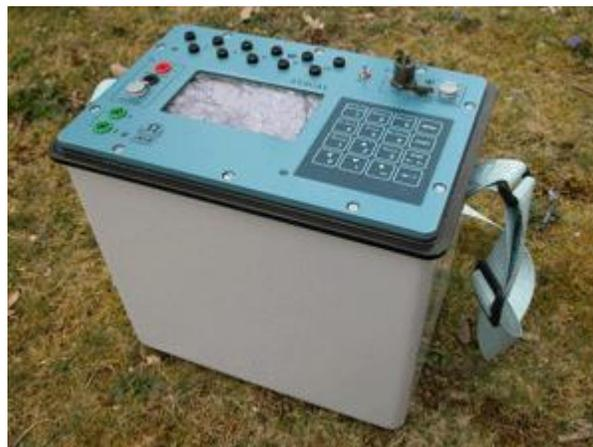
*Fig.4.1.1 Resistivimetro Syscal Pro Switch 48.*
