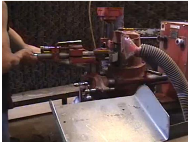
Máquina de conformado de las balatas.
