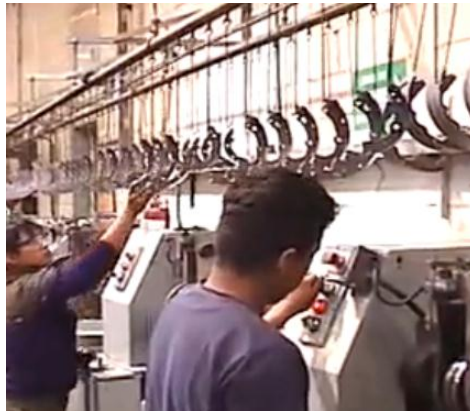
Zapata colocada en el transportador elevado.
