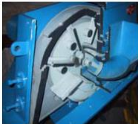
Turbina de la máquina de granallado.
