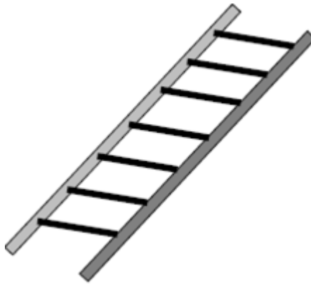
Figura 3.17 Escalera para cables
