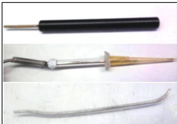
Figura 2.4. Electrodos empleados en Cronopotenciometría. Se muestran según se enlistan en el texto.
