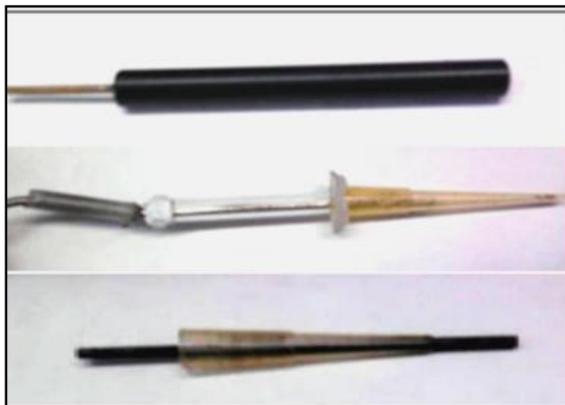
Figura 2.9. Electrodos empleados en Voltamperometría lineal. Se muestran según se enlistan en el texto.
