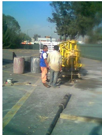
La prueba de penetración estándar consiste en hincar 60 cm el penetrómetro estándar de 3.5 cm de diámetro interior, por medio de golpes que le proporcionan un martinete de 63.5 Kg. que cae desde una altura de 76 cm, el índice de resistencia a la penetración de los materiales atravesados, se mide contando el número de golpes necesarios para avanzar los 30 cm intermedios.
