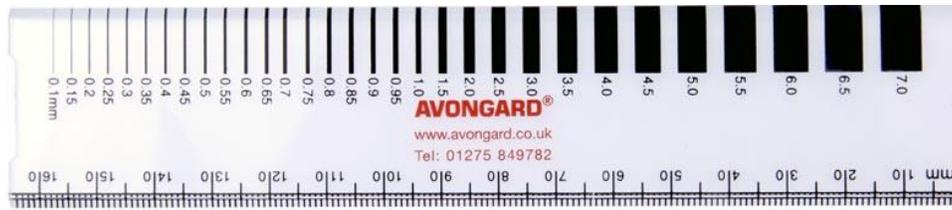
*Fig. 2.8 Regla para medir anchos de grieta*
