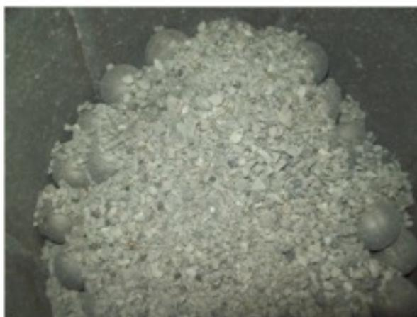
Figura 9. Alimentación al molino del mineral de Pb-Zn
