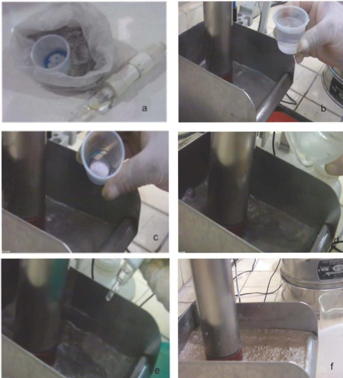
Figura 25. Flotación selectiva de zinc: a)adición de reactivos, b)ajuste del nivel de la celda, c)adición de Sulfato de cobre, d)ajuste del pH, e)adición de espumante y e)recolección de zinc.
