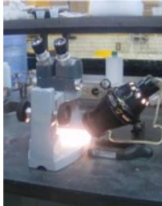
Figura 18. Microscopio American Optical para determinar tamaño de liberación.
