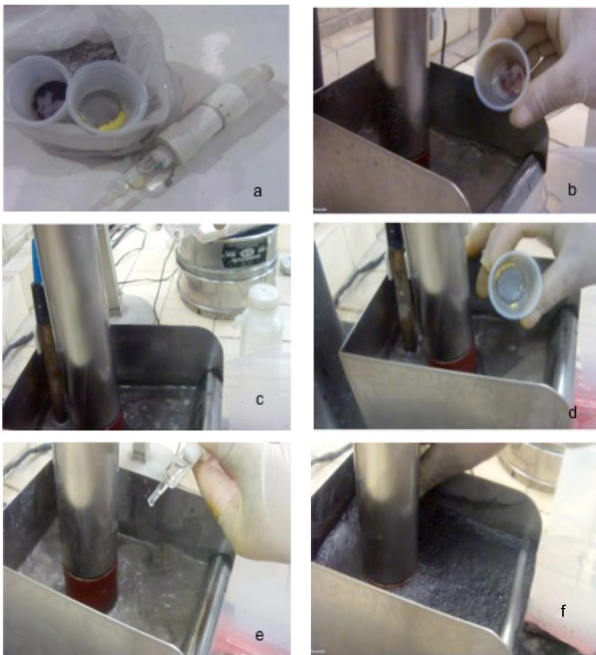
Figura 24. Flotación selectiva de plomo: a)adición de reactivos, b)adición de quebracho colorado, c)ajuste del pH, d)adición de XEK, e)adición de espumante y e)recolección de plomo.
