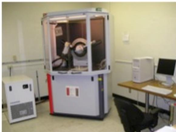
Figura 10. Difractómetro de Rx, Bruker D8-Advanced.
