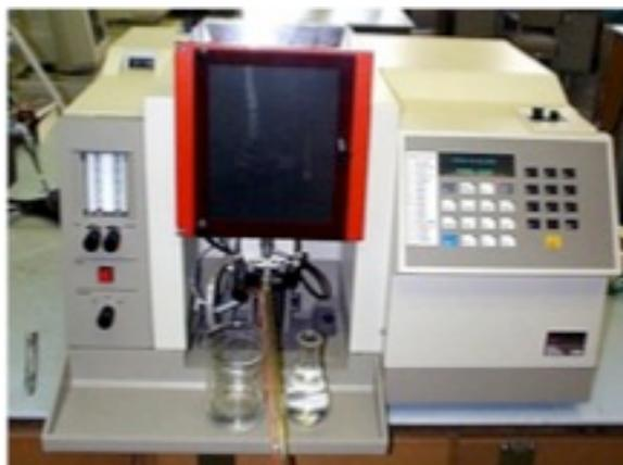
Figura 11. Espectroscopia de Absorción Atómica, Pekín Elmer 3100.
