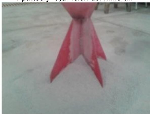
Figura 8. Cuarteo del mineral de Pb-Zn
