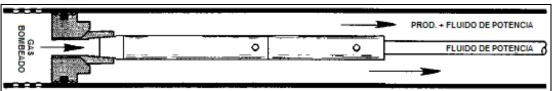
Fig. 1.3 Arreglo fijo en tubería de revestimiento.
