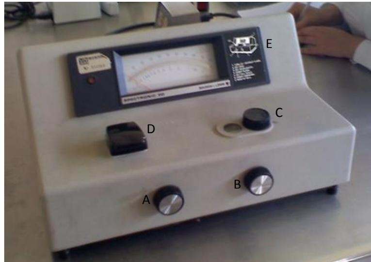
*Figura 3.4 Espectrofotómetro Baush and Lomb*
