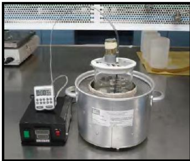
Figura 6.1 Termohidrolizador de lodos
