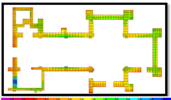
Figura 32 Esfuerzos axiales verticales en la base
