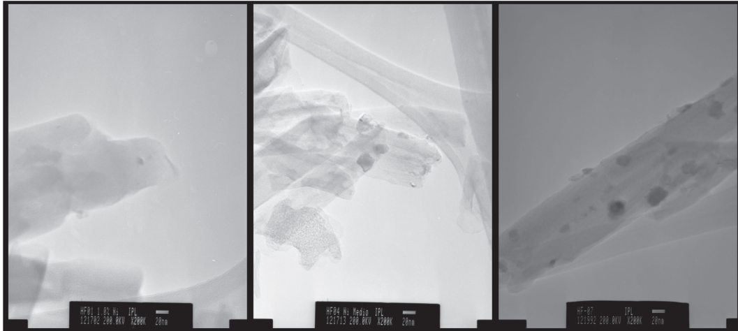
Figura 4-6: Imágenes de microscopía electrónica de transmisión para los catalizadores sintetizados con 1% (izquierda), 2% (centro) y 3% (derecha) en peso de níquel.
