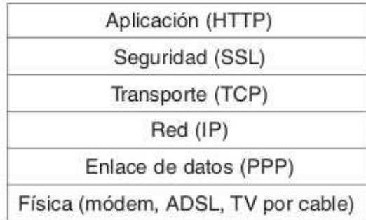
Figura 2.22. Capas (y protocolos) para una navegación de usuario doméstico con SSL.
