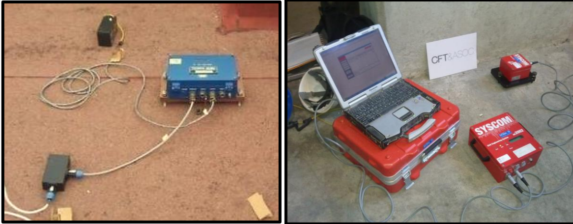
Figura 4.27.- Equipos de medición de vibraciones (acelerómetros).
