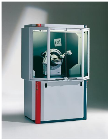
Imagen 2.1. Difractómetro de rayos X.
