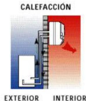
**Figura 3: Sistema de climatización para calefacción.** (Manual empresa DAIKIN “¿Cómo funciona el aire acondicionado?”)
