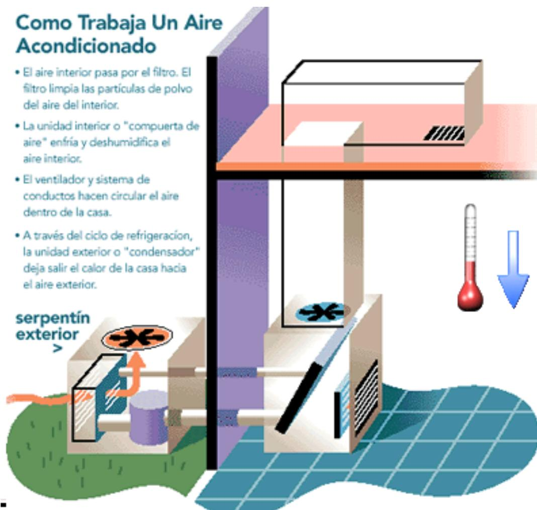
Figura 5: Funcionamiento de un aire acondicionado. (<http://www.arkcom.com.mx/unidad.html>)
