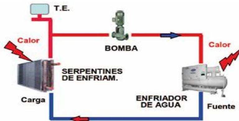
**Figura 21: Unidad generadora de agua helada.**
