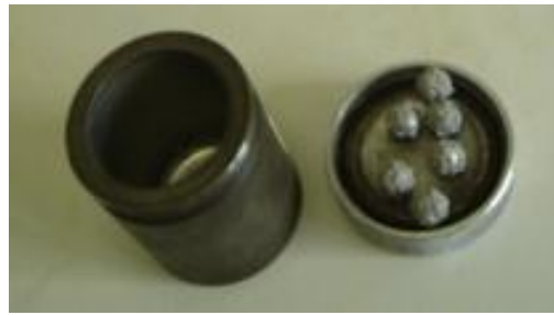
Figura 11. Muestra el equipo de mecano-síntesis de alta energía y el contenedor con los balines donde se colocan las muestras para procesar (Elaboración propia).
