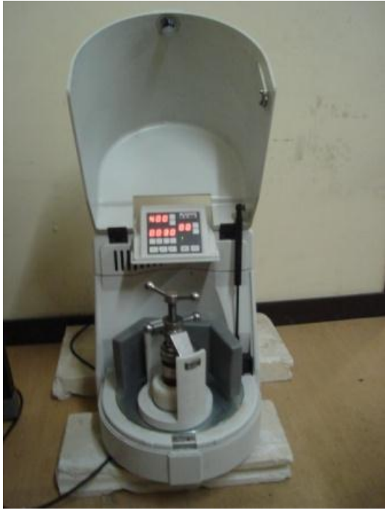
Figura 11. Muestra el equipo de mecano-síntesis de alta energía y el contenedor con los balines donde se colocan las muestras para procesar (Elaboración propia).
