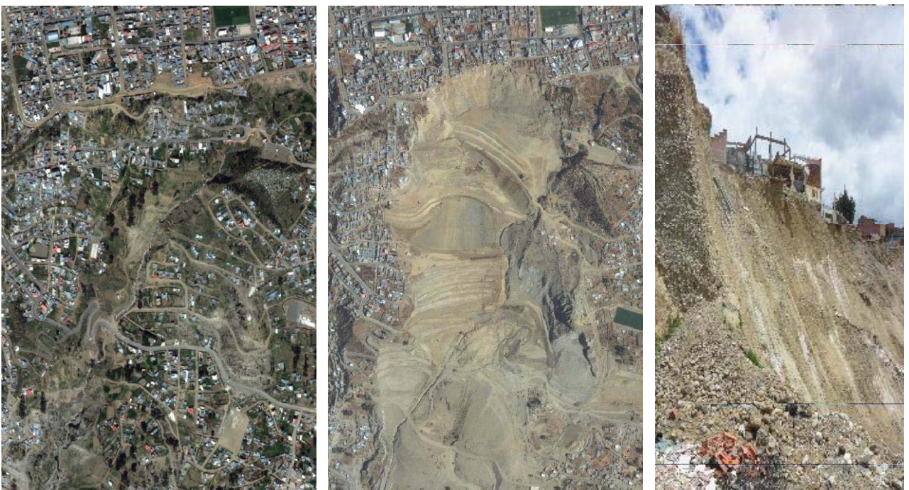
Antes y después. Fotografías aéreas del deslizamiento de Pampahasi sobre el barrio Valle de las Flores de Callapa, como se puede apreciar toda la textura urbana del lugar ha sido devastado no queda ni una sola vivienda en pie, el efecto se prolongó hacia el núcleo del pueblo de Callapa, que por efecto de las lluvias no tenía ya capacidad de resistencia, su tierra húmeda se hizo movediza dejando a muchas construcciones a expensas del capricho del azar.
