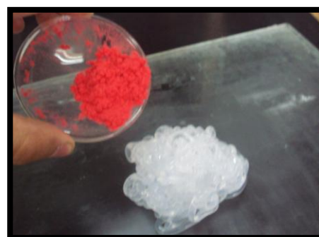
Fig. 32 Mezclado f. flock y silicona
