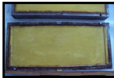
Fig. 28 Molde de yeso con medidas específicas para la obtención de muestras de silicón
