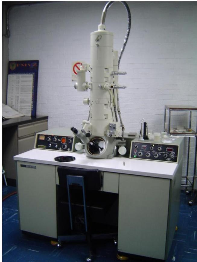
Fig. 3 Microscopio Electrónico de Transmisión.
