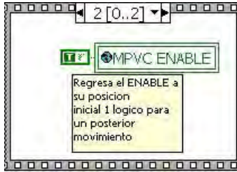
Figura A. 12 Habilitador a su estado anterior (Fuente: Propia)
