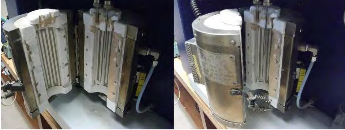
Figura 2.20 Estaciones y hornos (Fuente: Propia)
