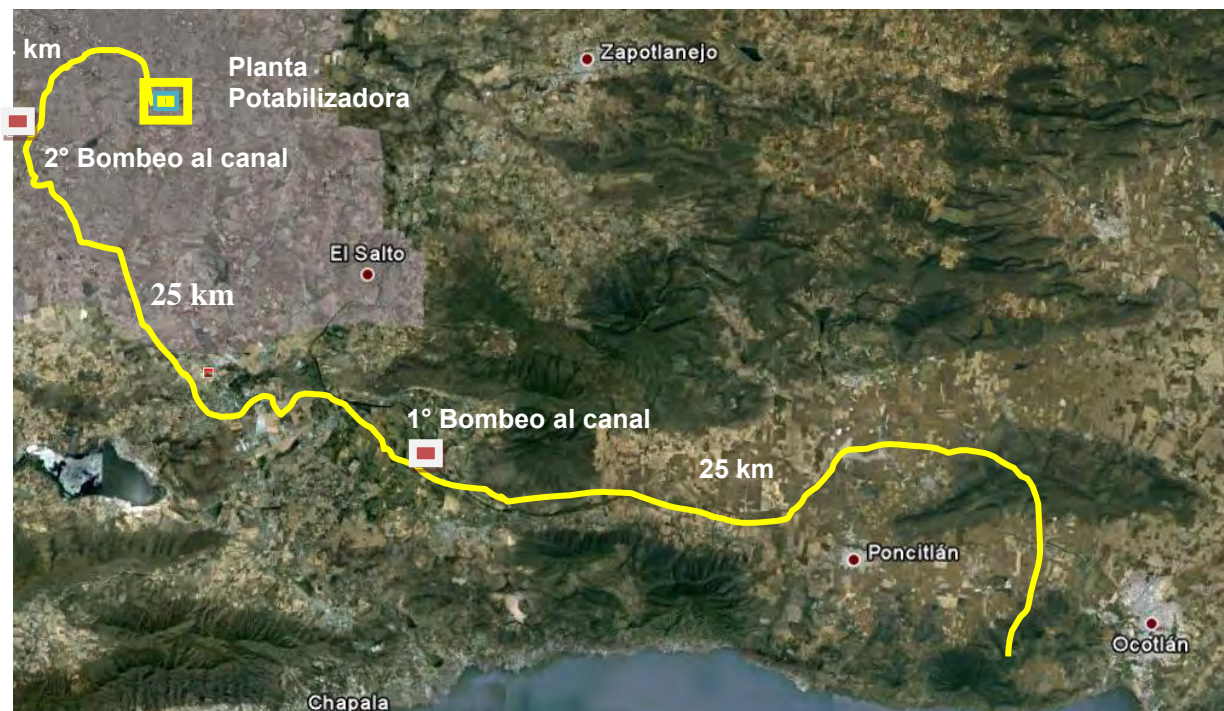
Trazo canales Atequiza las pintas a planta potabilizadora 1 er sistema Chapala - Guadalajara
