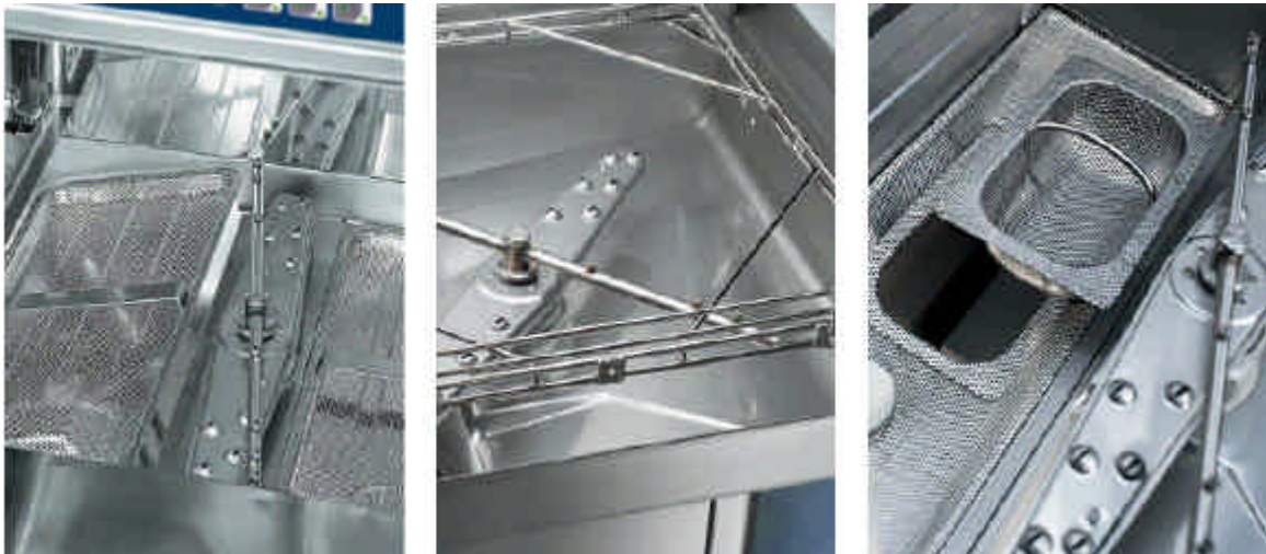
Figura 3.1.5 Componentes principales fabricados en acero Inoxidable AISI 304.
